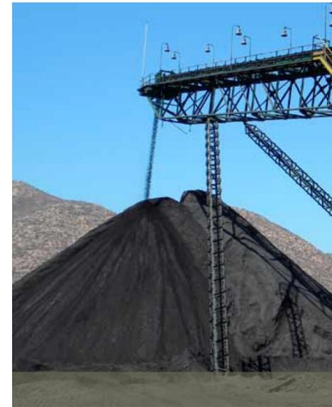
La producción de CAP Minería se distribuye en diferentes tipos de concentrados de minerales de hierro, los que se obtienen mediante métodos de Concentración Magnética. Los concentrados se clasifican fundamentalmente de acuerdo a su granulometría.
