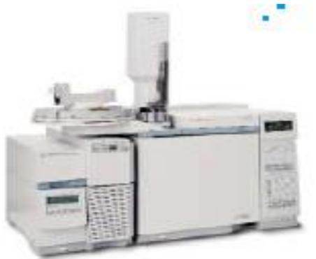
**Cromatógrafo de Gases:** permite analizar sedimentos, rocas y tejidos animales, y otras especies de elementos de importancia en estudios medioambientales (Agua, Riles y otros).
