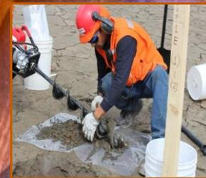
Vaciado de la muestra a balde
