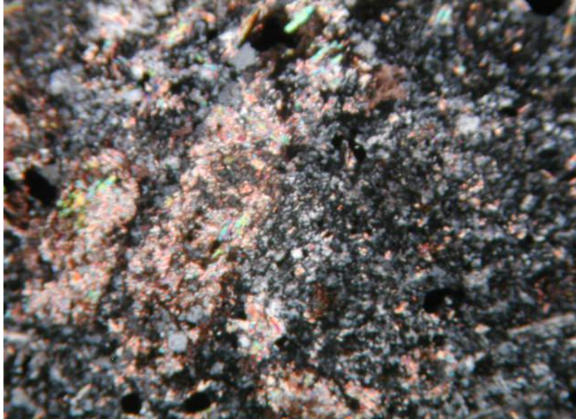
Sondaje DDH08-10: 128 metros. Cristales de plagioclasa alterados a sericita. Luz transmitida, nícoles cruzados, aumento 40 X.
