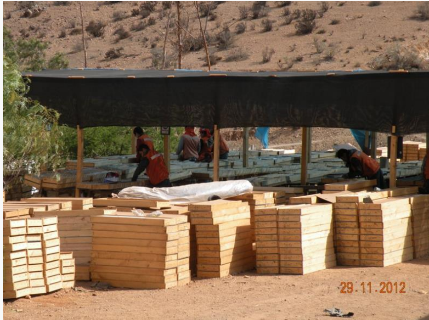
Medición de recuperación y parámetros geomecánicos.
