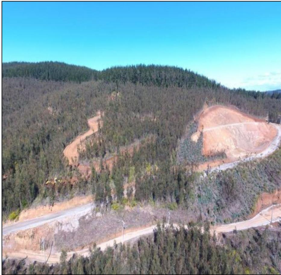
La minería se realiza por RA, con arranque directo con Excavadora y carguío a camiones convencionales
